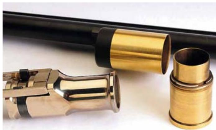
Da sinistra: l'estremità delle due aste di armamento del robusto insieme carrello-biella, tutto in acciaio cromato, il cilindro di presa gas o coppa convogliatrice e il nuovo pistone (senza elastomero e appesantito) che riceve la spinta dei gas. La doratura deriva dal trattamento allo zirconio.
