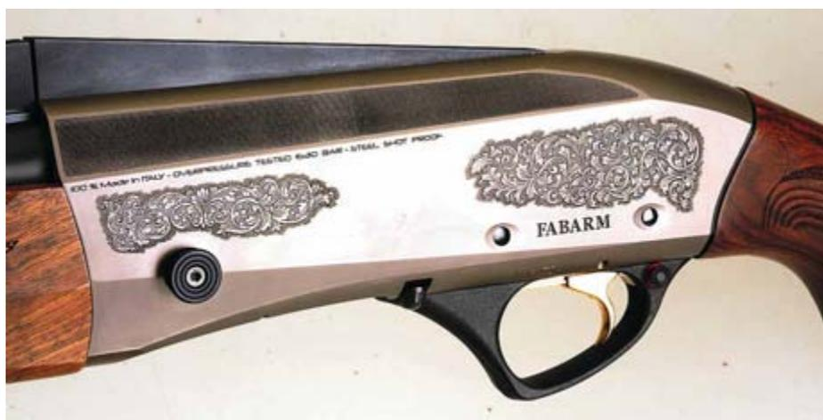
Il lato sinistro con il pulsante maggiorato di chiusura dell'otturatore. Il ponticello del guardamano in polimeri, di forma trapezoidale. In primo piano il pulsante del cut-off. Il grilletto è dorato e ha corsa regolabile di 15 mm.
