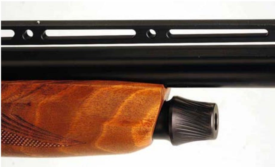
Ecco la zona del tappo serbatoio con l'astina. La bindella è in Ergal, alta 18 mm, conica 11x8 e ventilatissima, si nota il mirino intermedio.
