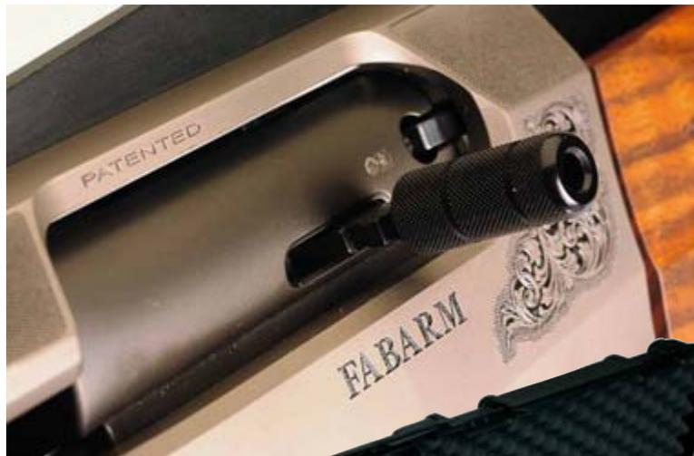
A sinistra: la manetta dell'otturatore sull'Xlr 5 velocity è un cilindretto lungo circa 20 mm.
