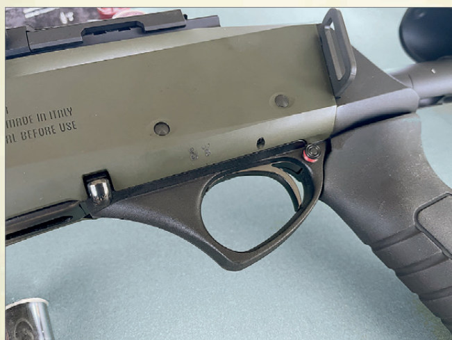
▲▲ Dettaglio del ponticello, ampio, e del pulsante triangolare della sicura manuale a traversino cui corrisponde, a sinistra, un cursore che mostra un anello rosso quando l'arma è pronta al fuoco. L'attacco per la cinghia può essere spostato da ore 9 a ore 12
