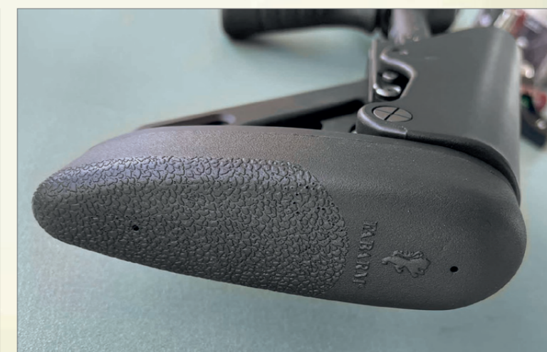
◀ Il calcio telescopico con tubo in Ergal si regola su cinque distanze tramite la leva seghettata al suo interno, mentre il nasello è regolabile su quattro altezze con il pulsante alla sua base
