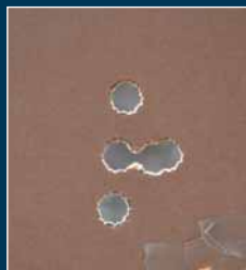
Rosata di cinque colpi a 20 metri con la palla Brenneke Ko di 28 grammi.
