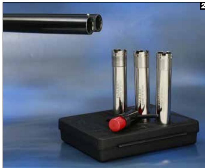
1. La cameratura è magnum, mentre la geometria dei tubi è del tipo Tribore Hp, con tripla conicità. La chiusura è affidata a due coppie di ramponi a triplice giro di compasso, affiancate. 2. La canna è corredata da un set di cinque strozzatori interni Inner Hp, che consentono l'impiego di pallini in acciaio anche con strozzatura piena, grazie al profilo iperbolico. 3. I quattro ramponi si inseriscono nella tavola di bascula e sono bloccati dal doppio tassello comandato dalla chiave di apertura, che si inserisce nei recessi ricavati alla base delle culatte. 4. Il calcio è all'inglese, in legno di noce selezionato di grado 2,5 lucidato a olio.
