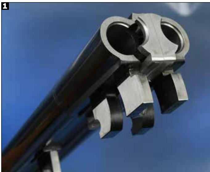
1. La cameratura è magnum, mentre la geometria dei tubi è del tipo Tribore Hp, con tripla conicità. La chiusura è affidata a due coppie di ramponi a triplice giro di compasso, affiancate. 2. La canna è corredata da un set di cinque strozzatori interni Inner Hp, che consentono l'impiego di pallini in acciaio anche con strozzatura piena, grazie al profilo iperbolico. 3. I quattro ramponi si inseriscono nella tavola di bascula e sono bloccati dal doppio tassello comandato dalla chiave di apertura, che si inserisce nei recessi ricavati alla base delle culatte. 4. Il calcio è all'inglese, in legno di noce selezionato di grado 2,5 lucidato a olio.
