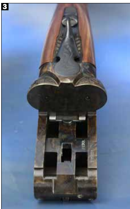
1. La cameratura è magnum, mentre la geometria dei tubi è del tipo Tribore Hp, con tripla conicità. La chiusura è affidata a due coppie di ramponi a triplice giro di compasso, affiancate. 2. La canna è corredata da un set di cinque strozzatori interni Inner Hp, che consentono l'impiego di pallini in acciaio anche con strozzatura piena, grazie al profilo iperbolico. 3. I quattro ramponi si inseriscono nella tavola di bascula e sono bloccati dal doppio tassello comandato dalla chiave di apertura, che si inserisce nei recessi ricavati alla base delle culatte. 4. Il calcio è all'inglese, in legno di noce selezionato di grado 2,5 lucidato a olio.
