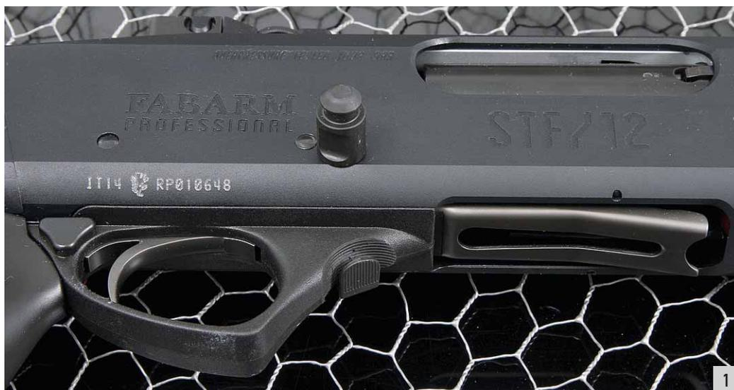
1. Il lato destro della carcassa, con in primo piano il piolo che blocca il calcio in posizione ripiegata. Davanti al ponticello c'è la leva di sblocco otturatore a cane armato, dietro il traversino della sicura (maggiorata).
